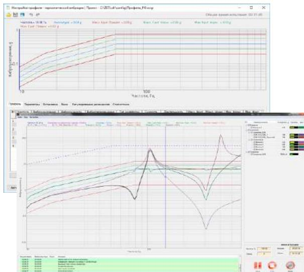
Проведение испытаний изделий на устойчивость к воздействию вибрации гармонического характера в указанном диапазоне частот или на фиксированных частотах в течение определенного промежутка времени. Определение динамических характеристик испытуемого изделия в «идеальных» условиях, а также регистрация основных резонансных частот и грубых механических дефектов на этапе разработки и выпуска изделия.
