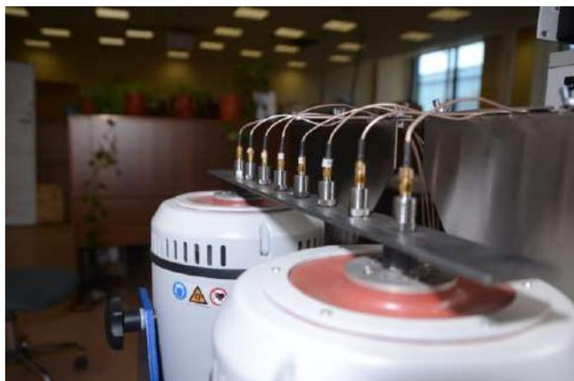
Встроенная система безопасности позволяет следить за параметрами как контрольного датчика, так и всех следящих, в соответствии с чем производить либо экстренную остановку испытаний, либо оповещение о регистрируемых изменениях.
