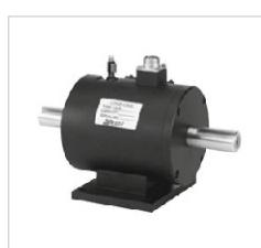
TRB датчик для измерения крутящего момента (1...2000 кгс\*; 1,5 м В/В)
