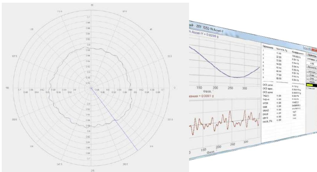
При необходимости организации беспроводной передачи данных и анализа крутильных колебаний в режиме реального времени система может быть дополнена телеметрической системой ZET 7172.
