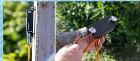
Датчик крепится с помощью магнитов
