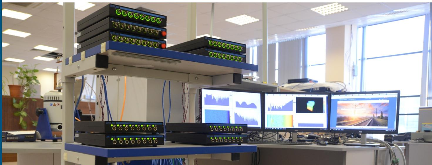
Программно-аппаратный комплекс позволяет производить вибрационные, акустические и гидроакустические измерения одновременно по большому числу каналов.
